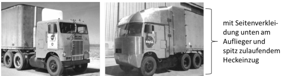
Abbildung 61 Sattelzug der NASA Windkanalmessungen aus 1978
