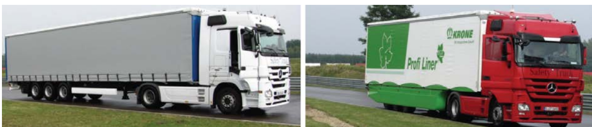
Abbildung 63 MB Actros 1 MP 3 mit Standardauflieger (l.) und optimiertem Auflieger (r.)
