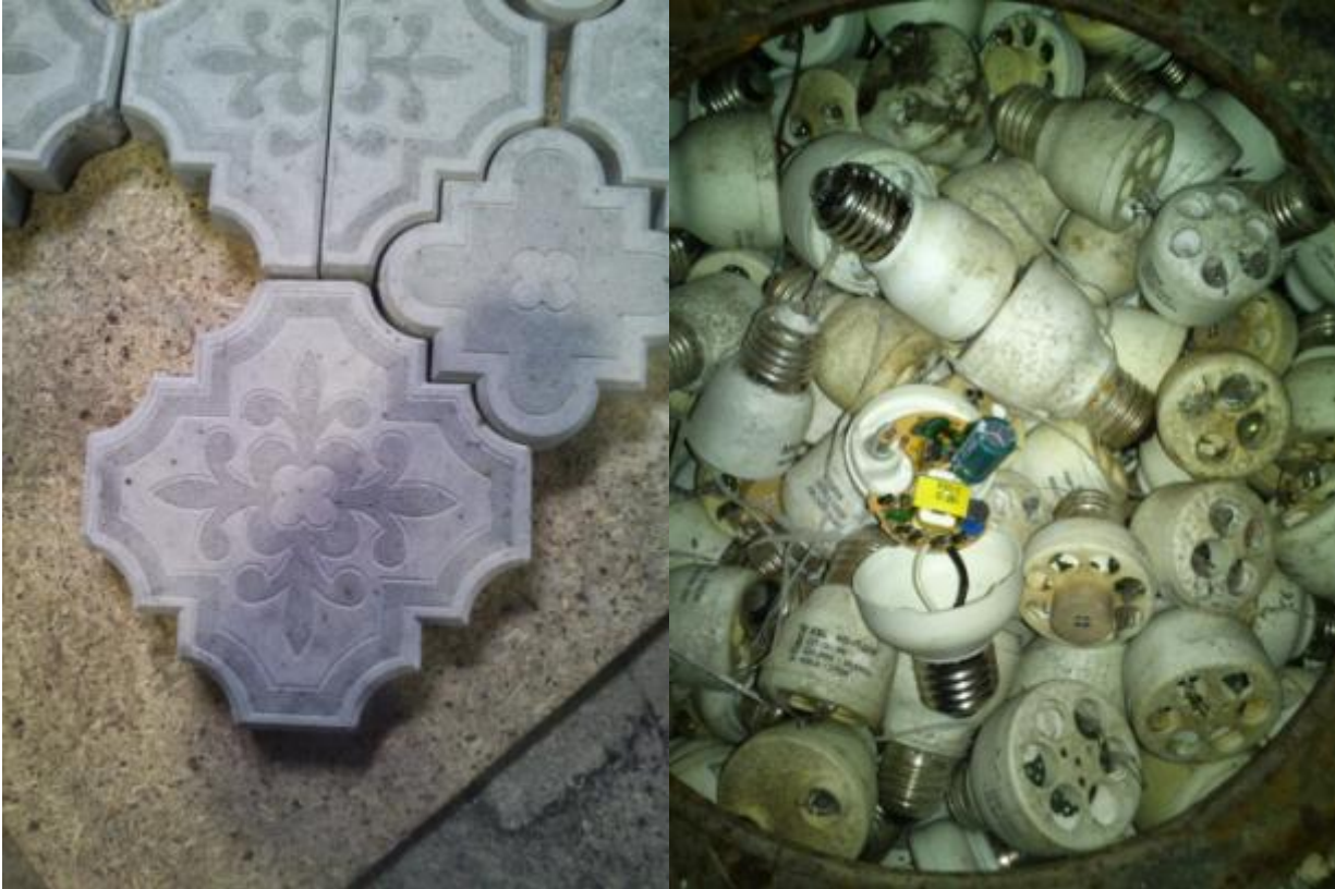
links: Baustoffe aus Beton mit Inertstoff als Zuschlagsstoff; rechts: Lampen- Sockel nach Behandlung , Quelle IFEU Iserlohn
