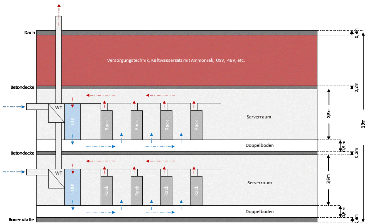
Abbildung 48: Schema des über Luft/Luft-Wärmeübertrager gekühlten Rechenzentrums mit kontrollierter Belüftung der Racks
