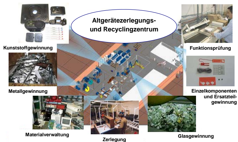
Abb.3: Prozesskombination in einem Altgerätezerlegungsbetrieb
