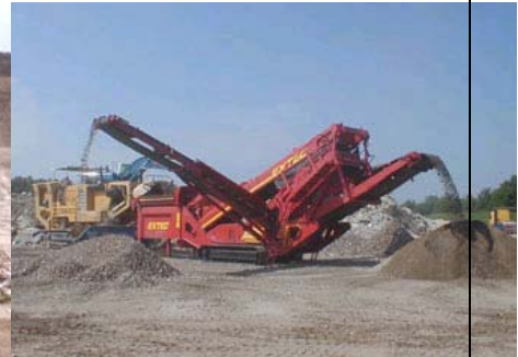
Abb. 4: Klassierung von Mineralgemischen mit Extec® Aggregat
