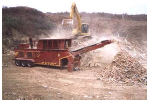
Abb. 3: Abtrennung von Holz aus Bau-schutt
