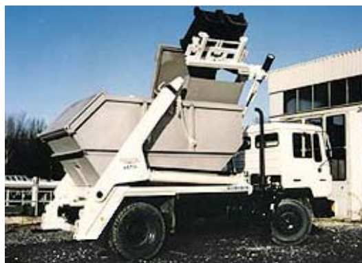
Abb. 5: Sonderkonstruktion: Seitenlader am Absetzkipper (Bildquelle: www.duenschede-fahrzeugbau.de )
