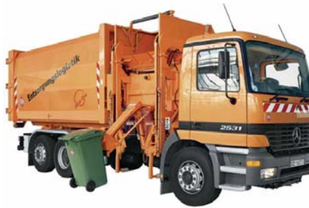
Abb. 1: Echter Seitenlader mit Wechselaufbau (Bildquelle: www.otto-environment.com )
