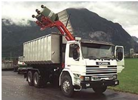
Abb. 4: Seitenlader ohne Verdichtungseinrichtung, z.B. für Glas (Bildquelle: www.duenschede-fahrzeugbau.de )
