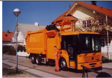
Abb. 2: Unechter Seitenlader mit Wechselaufbau (Bildquelle: www.ries-pressen.de )
