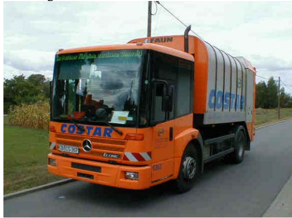
Abb. 3: Drehtrommelfahrzeug mit low-entry Fahrerhaus "Econic" (Fahrzeug: FAUN Umwelttechnik GmbH)
