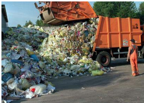
Abb. 4: Entleerung eines Fahrzeugs mittels Pressplatte (Fahrzeug: Haller Umweltsysteme GmbH & Co KG)
