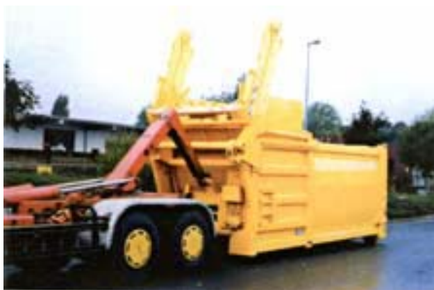
Abb. 4: wechselbares Frontlader-System auf Abrollcontainer-Chassis
