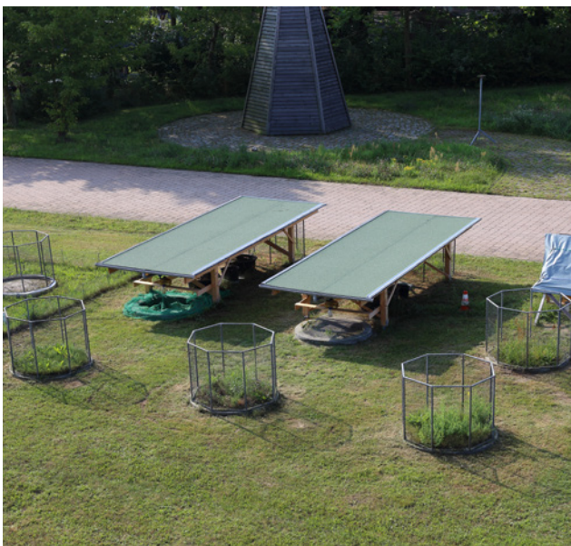
Lysimeteranlage mit künstlichen Dächern aus einem Forschungsprojekt (Biozide in Dachmaterialien)
