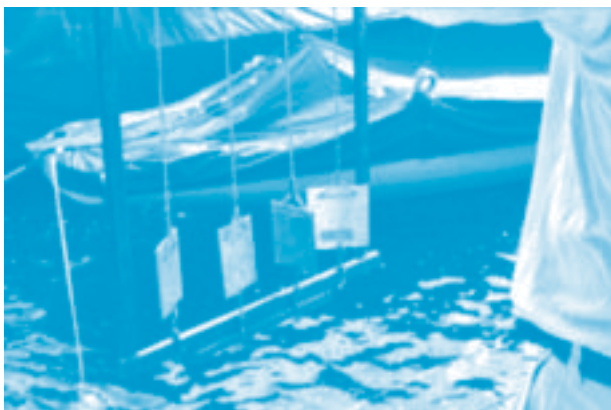
Untersuchung von unterschiedlichen Antifoulings durch Plattentests im Hafen.
