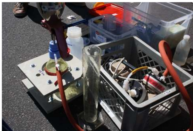
Abb. 48: Vorrichtung zur Filtration der Sestonproben.
