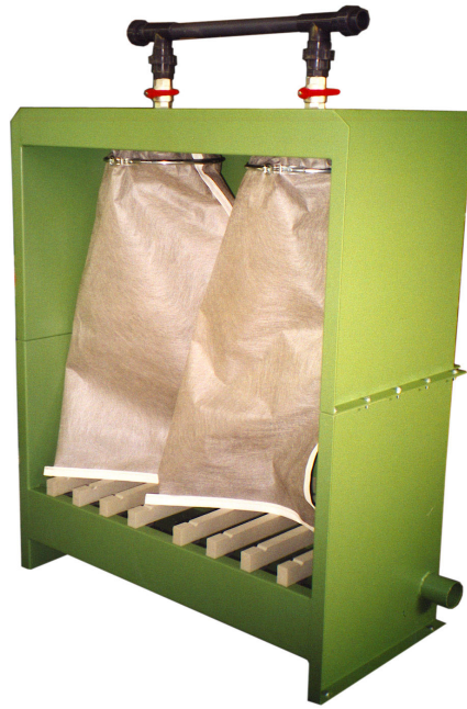
Anhang 5, Abb. 17: Sackfilter zur Klärschlammmentwässerung und Trocknung (System Panholzer)
