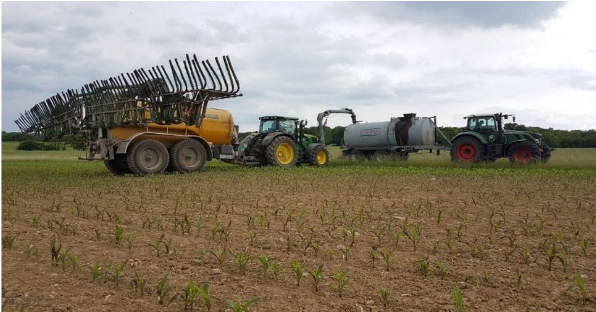
Abb. 11: Umpumpen der Gülle vom Transport- zum Ausbringfass
