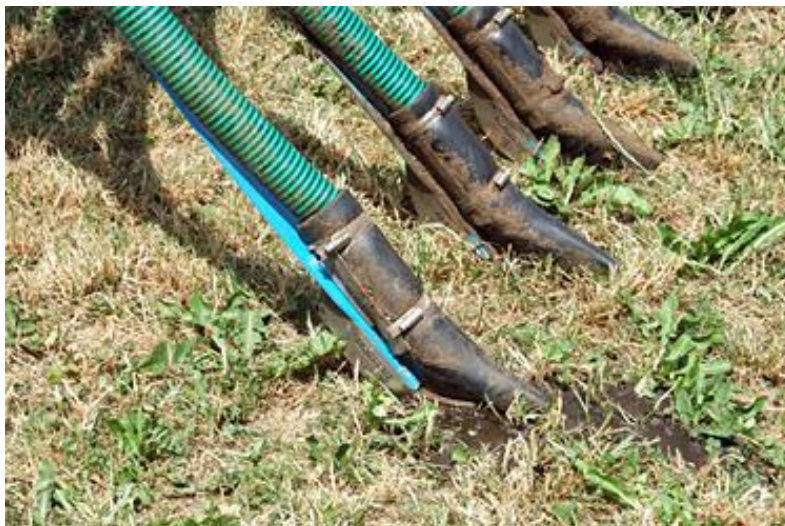
Abb. 15: Schleppschuh im Detail
