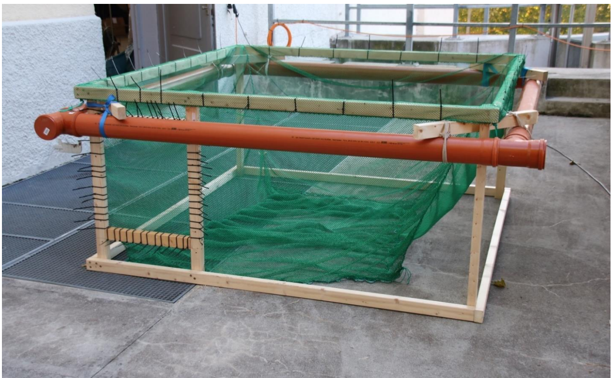
Abbildung 60: Fangkäfig zur Befestigung an einem Hamennetz für einen Korridor mit 1,3 m/s Durchfluss. Durch die großzügige Dimensionierung wird eine geringe fangbedingte Schädigung erreicht.
