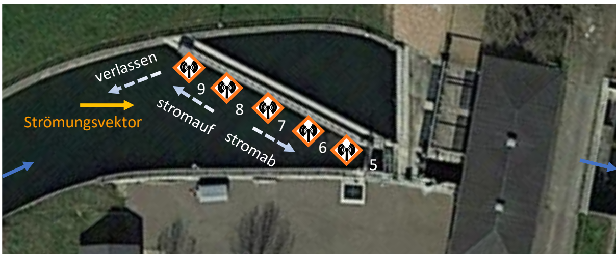
Abbildung 27: Anordnung der Radioantennen vor dem Leitrechen und Charakterisierung der definierten Bewegungsrichtungen. Der gelb eingezeichnete Strömungsvektor trifft im Winkel von 30° auf den Rechen, Quelle Luftbild Google Earth.
