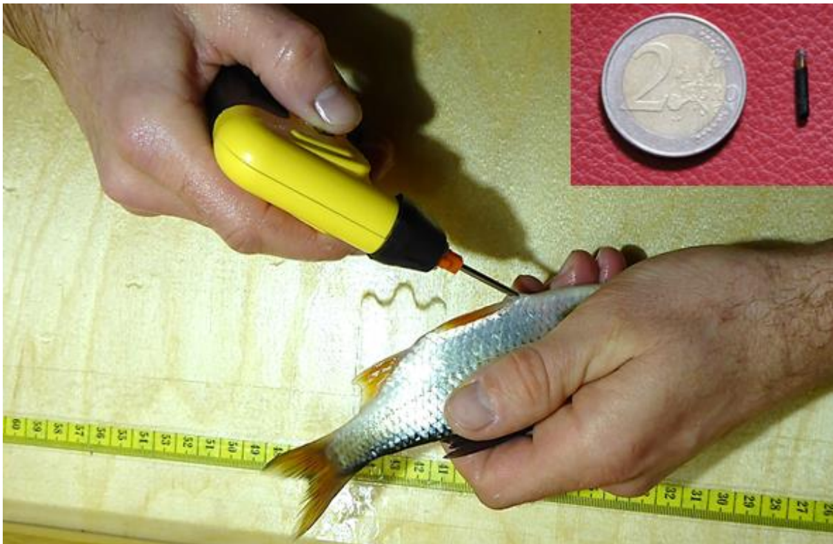
Abbildung 29: Intraabdominale Injektion eines 12 mm langen HDX-Tags, Einschub rechts oben zeigt den verwendeten Tag im Maßstabsvergleich zu einer 2 Euro Münze
