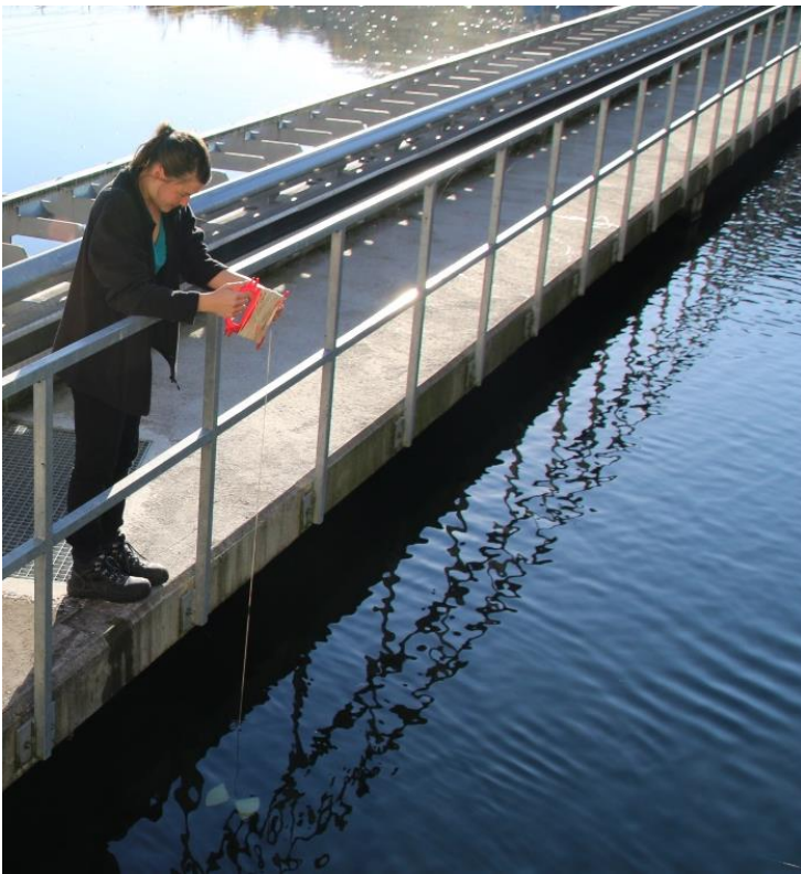
Abbildung 16: Ermittlung der Sichttiefe mittels Secchi-Scheibe
