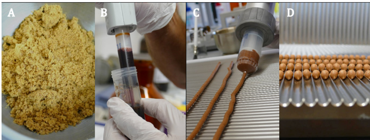
Abbildung 1: Herstellungsprozess der Futterpellets
