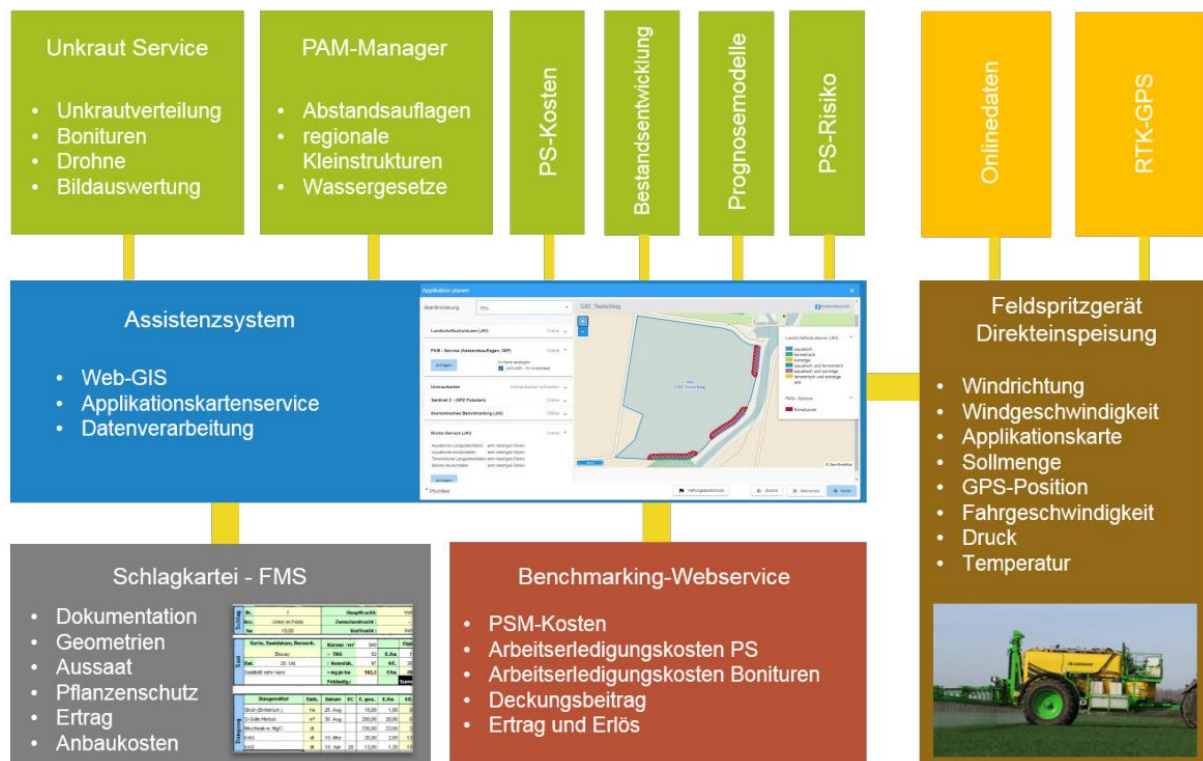
Abbildung 19: Systemarchitektur des Assistenzsystems zur teilflächenspezifischen Applikation
