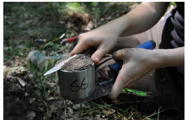
Abbildung 9: Entfernung des Überstands mithilfe eines Messers
