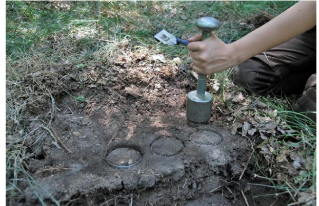
Abbildung 5: Einschlagen der Stechzylinder mittels Schlaghaube
